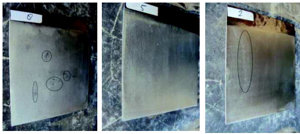
B 1 B 2 B 3 Gambar 2. Baja hasil elektroplating dengan variasi quenching 50°C; 60°C dan 80°C kuat arus 8,6A
