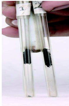
Gambar 4 Sifat kemagnetan serbuk hasil penelitian
