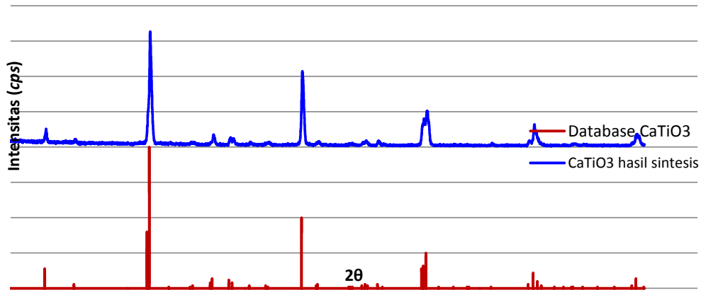
Gambar 2. Hasil analisis Difraktogram sinar-X oksida perovskit \text{CaTiO}_3
