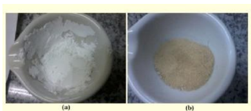
Gambar 1.1 Oksida perovskit (a) sebelum kalsinasi dan (b) setelah kalsinasi
