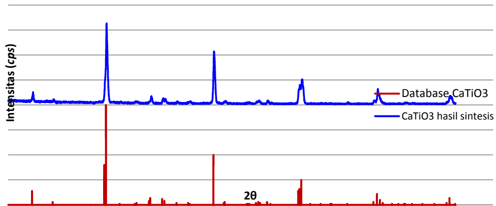
Gambar 2. Hasil analisis Difraktogram sinar-X oksida perovskit CaTiO 3
